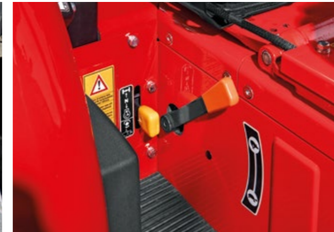
SELECTOR MECÁNICO Selector mecánico de 2 velocidades (trabajo y desplazamiento).
