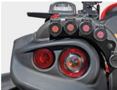
ACOPLAMIENTOS TRASEROS RÁPIDOS Sistema hidráulico electroproporcional con mando joystick "JPM" con doble sistema de seguridad para el operador y centralita de mando integrada con configuración y ajustes personalizables - 12 acoplamientos rápidos traseros.
