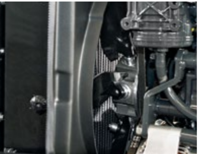
ACS (Air Clean System) Ventilador del motor con inversión del flujo. Reduce la necesidad de limpiar las rejillas frontales, haciendo más constante la refrigeración del motor.
