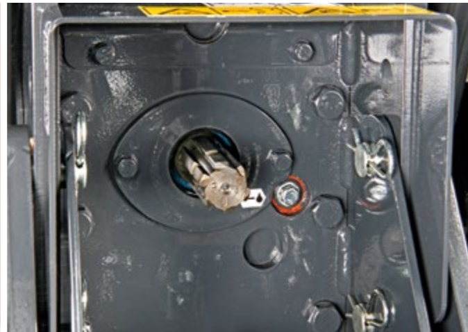
TDF De dos velocidades: 540/ 540E rpm (de serie) con acoplamiento electrohidráulico progresivo; 540/ 1000 rpm* sincronizado con la velocidad del cambio. El eje de la TDF, de tipo ASAE1 3/8, es único para todas las velocidades.
