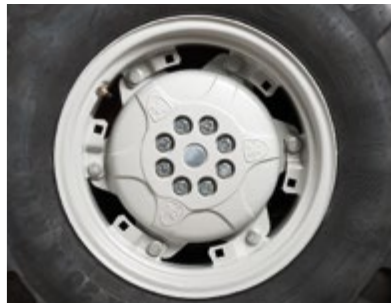
BRIDAS TRASERAS DE FUNDICIÓN Con seis fijaciones, para equilibrar el tractor.
