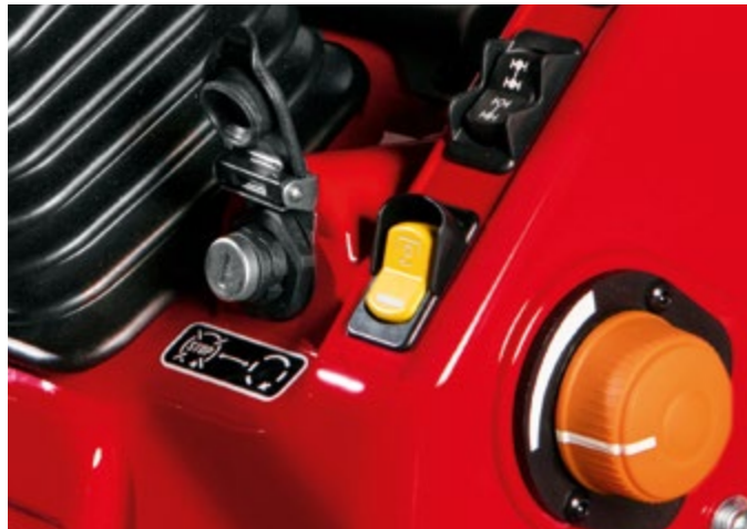
TDF De dos velocidades: 540/ 540E rpm (de serie) con acoplamiento electrohidráulico progresivo; 540/ 1000 rpm* sincronizado con la velocidad del cambio. El eje de la TDF, de tipo ASAE1 3/8, es único para todas las velocidades.
