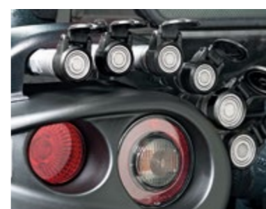
ENCHUFES RÁPIDOS TRASEROS DE CARA PLANA Conexión fácil; no se derrama aceite, mayor limpieza.
