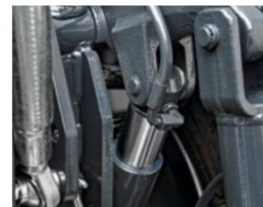
SUSPENSIÓN HIDRÁULICA Elevador trasero con suspensión hidráulica UNIFLEX.
