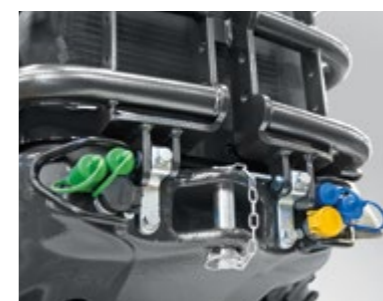
ENCHUFES RÁPIDOS DELANTEROS Elevador delantero > 6 enchufes duplicados de los traseros, de los cuales 2 son de doble efecto + 1 de caudal continuo con regulación electrónica y 1 de simple efecto.
