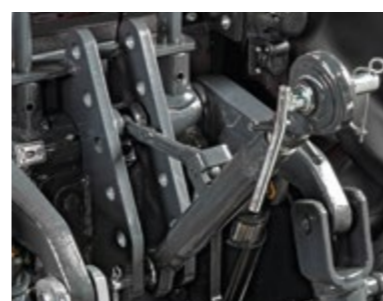
ENGANCHE 3.er PUNTO REALZADO Para facilitar la regulación de los equipos.
