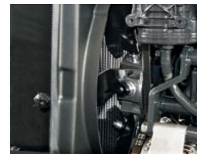
ACS (Automatic Clean System) Ventilador del motor con inversión del flujo. Reduce la necesidad de limpiar las rejillas frontales, haciendo más constante la refrigeración del motor.
