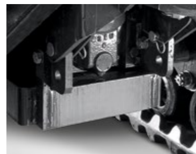
CONTRAPESOS Contrapesos suplementarios para un mejor equilibrado del tractor.
