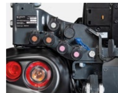
SISTEMA HIDRÁULICO Equipo hidráulico electroproporcional controlado por el joystick "JMC" con doble sistema de seguridad operadore y unidad de control integrada con configuración ajustes personalizables - 12 tomas hidráulicas con conexión rápida - Mando externo elevador.
