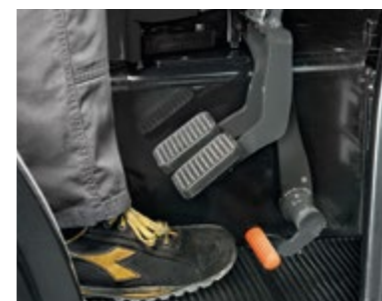
FRENOS DE DIRECCIÓN Para reducir aún más el radio de giro.
