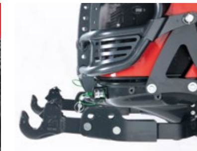
ELEVADOR DELANTERO Dispositivo auxiliar con brazos regulables y enganches rápidos dotado de bullbar. El elevador delantero permite labores en combinación con los equipos traseros.
