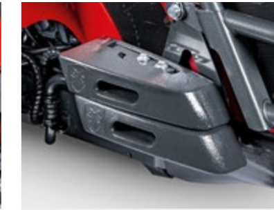
LASTRES DELANTEROS Perfectamente integrados en la carrocería, no alteran el paso ni el galbo del tractor.
