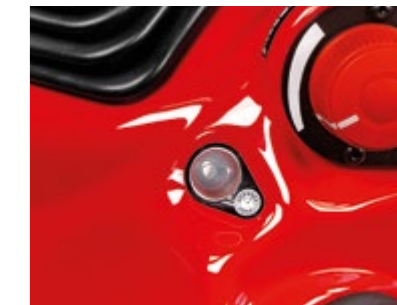
CRUISE CONTROL Control electrónico de la velocidad de avance y de las revoluciones. Memoriza y modula la velocidad del tractor a discreción del operador.
