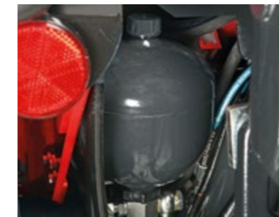
DUMPING compensa los esfuerzos transmitidos por los equipos, aumentando el confort y contribuyendo a preservar el tractor y el conductor de posibles daños.
