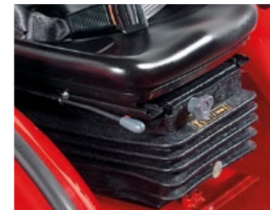
SUSPENSIÓN NEUMÁTICA Resorte de asiento neumático con regulación continua del peso del conductor de 50 a 130 kg y regulación continua de la altura.
