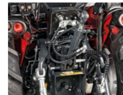
TIRANTE HIDRÁULICO Y TERCER PUNTO Optimiza el posicionamiento y la inclinación de los equipos.
