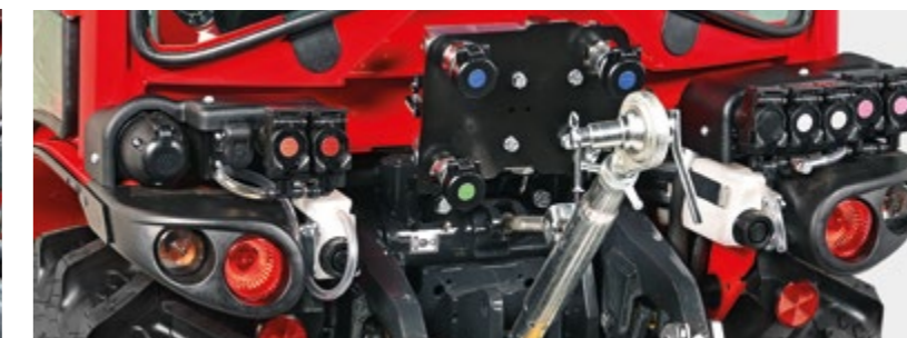
ACOPLIAMIENTOS RÁPIDOS TRASEROS Sistema hidráulico modular con equipamiento máximo de hasta 11 acopliamientos hidráulicos divididos entre impulsión continua, doble efecto y retorno libre. Todas las conexiones tienen tubos hidráulicos de sección grande para reducir las pérdidas de carga y mejorar la eficiencia del sistema.
