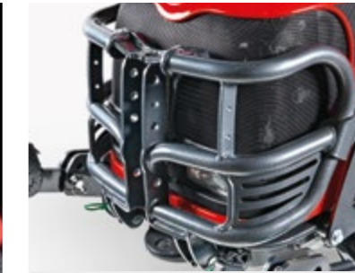
BULLBAR Elemento de tubos de acero para proteger la carrocería; integra el enganche del tercer punto en la configuración con elevador delantero.
