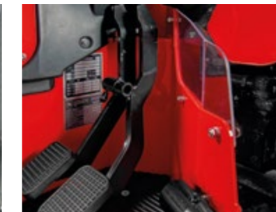
PROTECCIÓN CONTRA EL POLVO Protege al operador del polvo, las ramas, etc.
