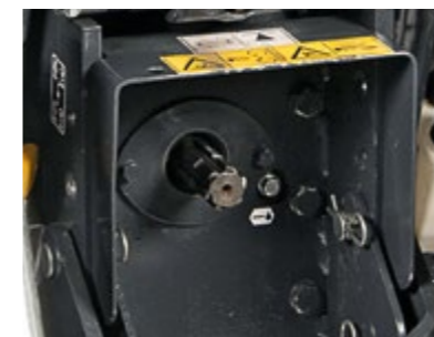
TOMA DE FUERZA Cambio con TDF trasera 540/1000 rpm
