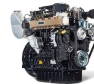
Los propulsores Stage V son los mejores de la categoría, y permiten las máximas prestaciones de par y potencia, consumos mínimos, menos ruido y menores emisiones de carbono. Se trata de un motor Kohler de 4 cilindros (2482cm<sup>3</sup>) con aspiración turbo e inyección Common Rail, con una potencia de 75hp a 2300 rpm y un par máximo de 310 Nm a 1500 rpm.
